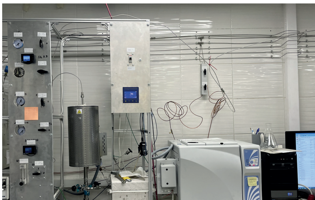
Каталитический реактор высокого давления для процессов в сверхкритических условиях с принадлежностями, Nanaltesco
