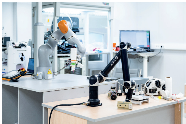
In situ биопринтеры на основе роборуки RoboPRO и на основе роборуки Kuka.
