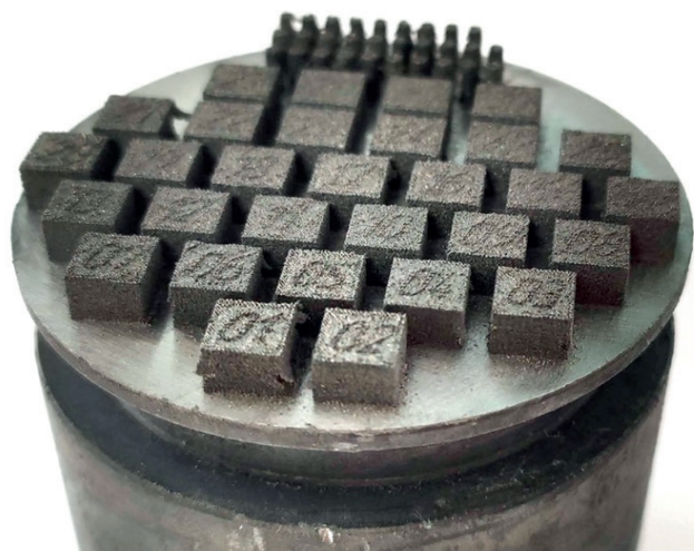
Кубические и цилиндрические образцы \text{Nd}_2\text{Fe}_{14}\text{B} после 3D-печати
