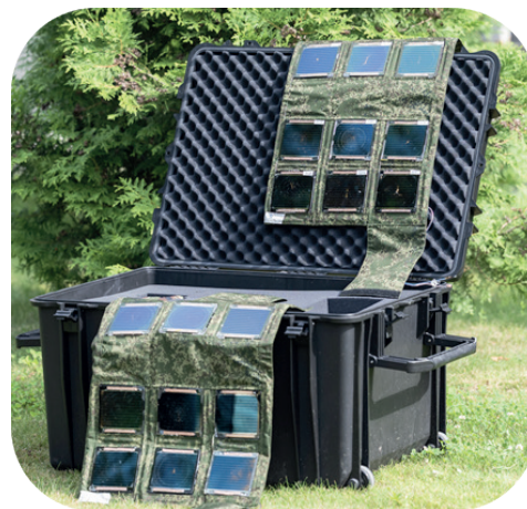
Макет солнечной батареи на основе перовскитных фотомодулей площадью 1600 см 2
