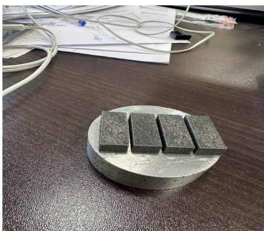
Образцы AlSi10Mg + 20% W2B5 после 3D-печати
