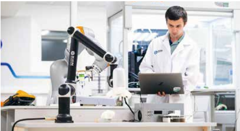
Инженер НОЦ Биомедицинской инженерии Александр Левин испытывает биопринтер для печати in situ
