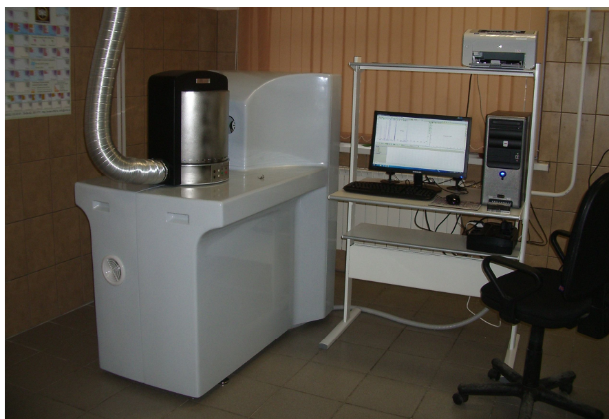
Рисунок 17 – Установка для проведения атомно-эмиссионного анализа на базе спектрометра высокого разрешения «Гранд»
