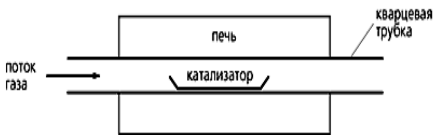
Рис. 6.2.1. Схема установки для получения углеродных нанотрубок методом химического осаждения на катализаторе.
