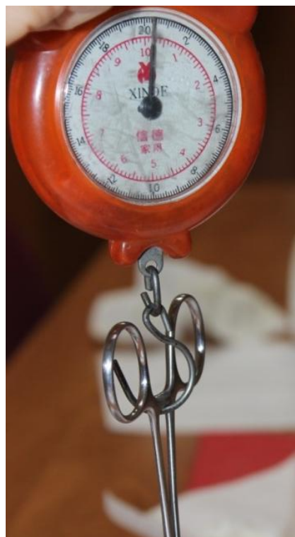
Рисунок 4.18 – Измерение усилия при извлечении якорной клипсы
