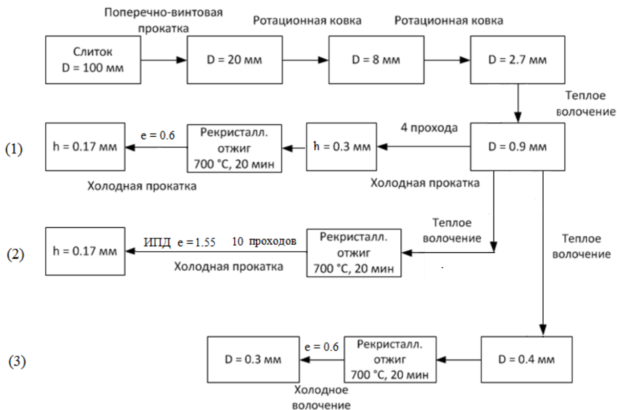
Рисунок 1.12 – Схема технологической цепочки получения заготовок для исследований: прокатка ленты с умеренной деформацией e = 0.6 (1); интенсивная пластическая деформация ленты e = 1.55 (2); волочение проволоки с деформацией e = 0.6 (3)
