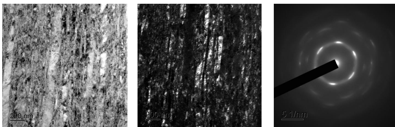
Рисунок 1.24 – Микроструктура сплава Ti–50.2ат. %Ni после холодного волочения с накопленной деформацией \epsilon = 0.6 ; ось зоны \langle 111 \rangle_{\text{В2}}
