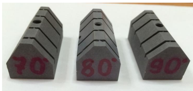
Рисунок 4.6 – Шаблоны для деформирования клипсы на заданный угол при наведении ЭПФ
