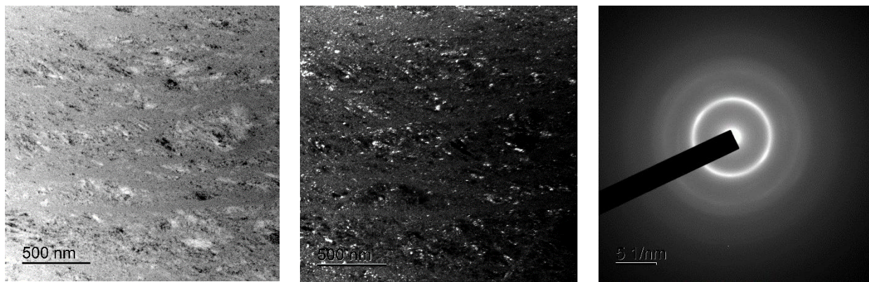
Рисунок 1.19 – Микроструктура сплава Ti–50.7%Ni после интенсивной пластической деформации прокаткой ( \epsilon = 1.55 )
