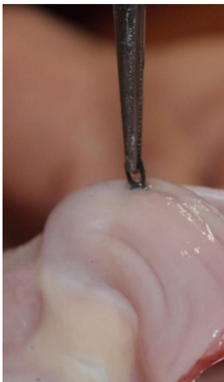
Рисунок 4.18 – Измерение усилия при извлечении якорной клипсы
