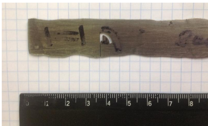
Рисунок 4.31 – Эскиз устройства (а) и полоса никелида титана с профилем вырезанного образца (б)
