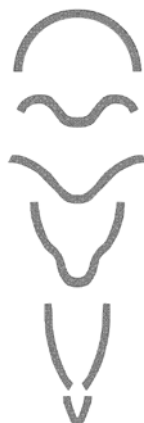
Рисунок 3.6 – Форма деформации и разрушения полусферической облицовки
