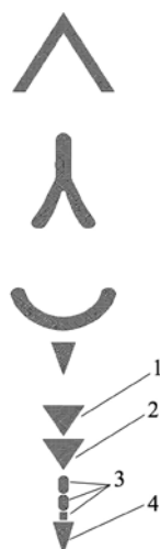
Рисунок 3.5 – Форма деформации и разрушения конической облицовки
