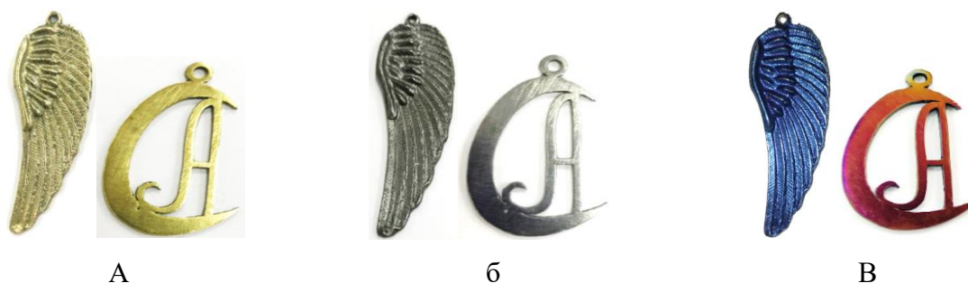
Рисунок 164 - Полученные двухслойные покрытия на декоративных изделиях: а – изделия без покрытий (латунь ЛС 59-1); б – изделия с покрытием Cr–Al–Ti–B–N (Режим Р4); в – изделия с покрытием Cr–Al–Ti–B–O–N (Режим D5 и D3)
