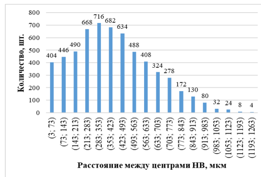
Рисунок 4 – Статистика распределения расстояний между полиэдрами-соседями (а, б, в, г) для четырех изображений неметаллических включений (нетравленные шлифы из стали 38ХНЗМФА площадью ~320 мм 2 каждый)
