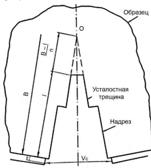
Рисунок 12 – Схема определения критического раскрытия трещины: V_c – смещение берегов трещины, соответствующее критическому моменту ее распространения; B – высота образца; O – центр вращения и длина усталостной трещины с надрезом l ; L_0 – расстояние от центра вращения до края образца; z – расстояние от места крепления датчика смещения до образца; n – коэффициент вращения берегов трещины;
