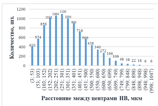
Рисунок 4 – Статистика распределения расстояний между полиэдрами-соседями (а, б, в, г) для четырех изображений неметаллических включений (нетравленные шлифы из стали 38ХНЗМФА площадью ~320 мм 2 каждый)
