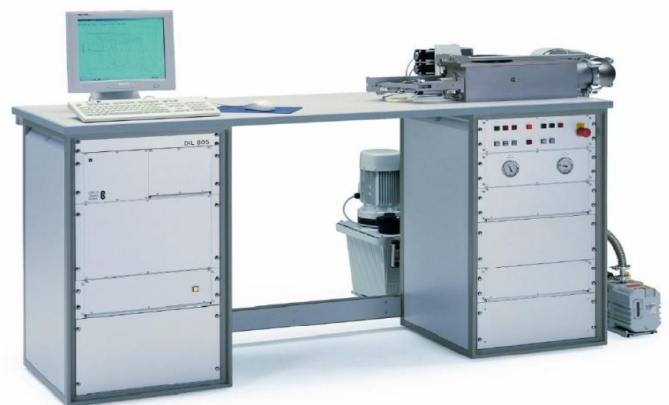
Рисунок 2 – Закально-деформационный дилатометр DIL-805A/D
