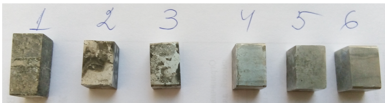
Рисунок 5.11 – Общий вид образцов после испытаний на коррозионностойкость: 1 – Al-4Ca-2Ce-2Ni, 2 – Al-3,5Ca-3Mg-10Zn, 3 – Al-3,5Ca-3Mg-10Zn-0,4Zr, 4 – Al-2Ca-8Ce, 5 – Al-6,5Ca-3,5Ce, 6 – Al-5Ca-3Ce
