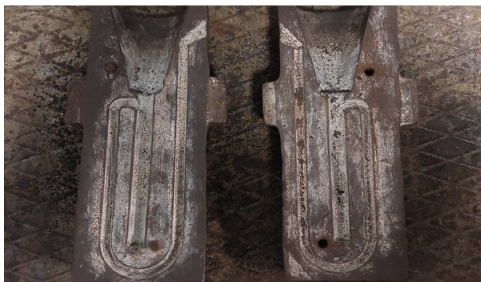
Рисунок 2.13 – U-форма для испытания сплавов на жидкотекучесть
