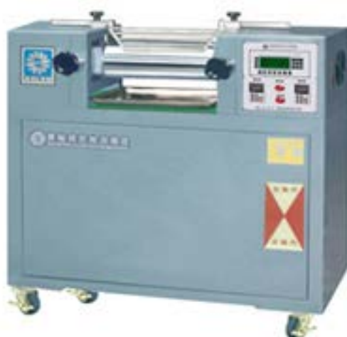
Рисунок 19 – Лабораторные вальцы типа УВ-6175
