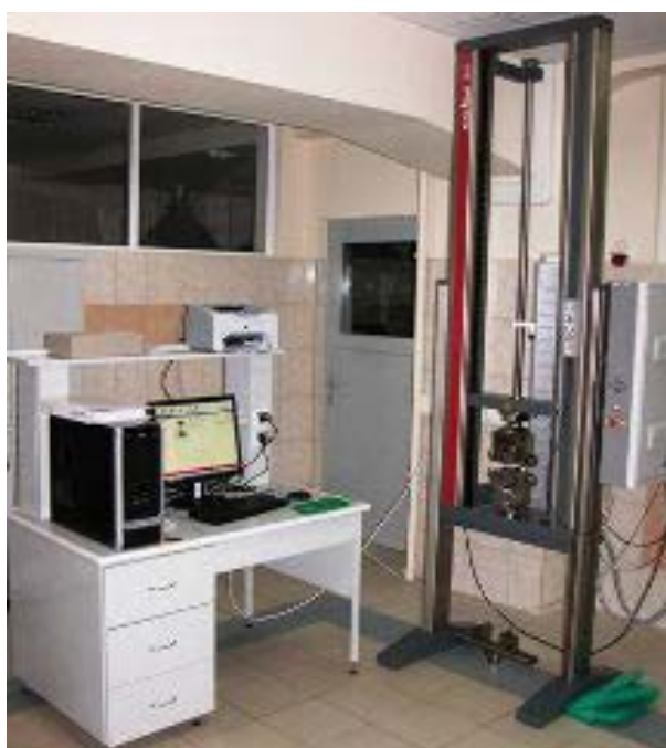
Рисунок 23 – Универсальная испытательная машина ZWICK/ROELL Z020
