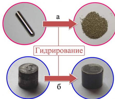
Рисунок 90 – Демонстрация устойчивости объёмных образцов TiFe к гидрированию: монолитный выплавленный и отлитый в электродуговой печи (а), полученный механохимическим синтезом с последующей консолидацией (б)
