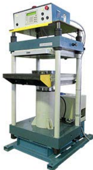
Рисунок 18 – Вулканизационный пресс типа АПВМ-904
