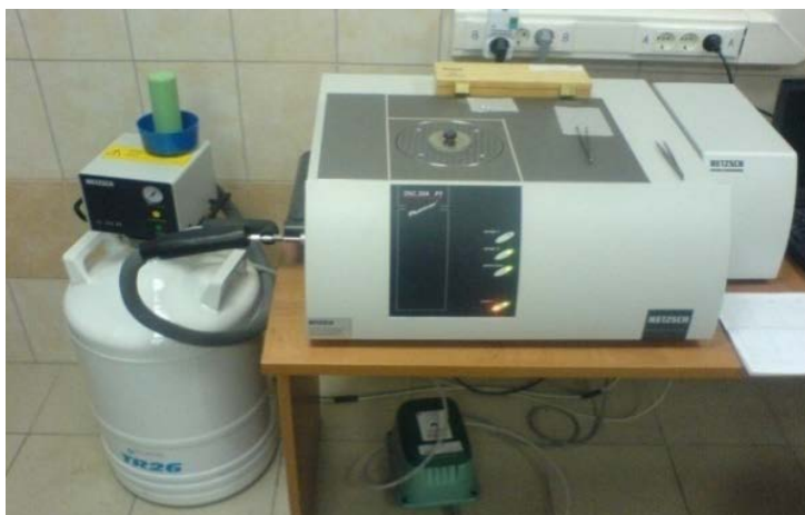
Рисунок 14 – дифференциальный сканирующий калориметр (ДСК) NETZSCH DSC 204 F1 Phoenix
