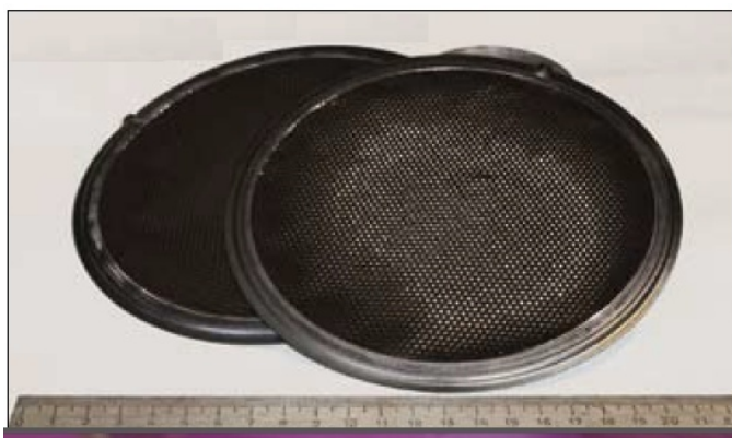
Рисунок 8 – Мембранные элементы с диаметром 150 мм [148]
