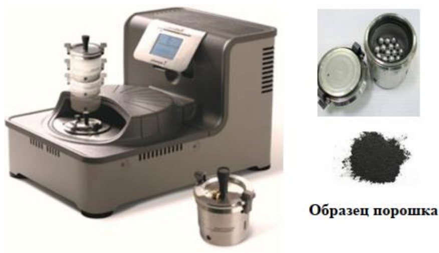
Рисунок 2.4 – Схематическое изображение механической системы помола (линейка Pulverisette 7 premium, Fritsch, Германия).
