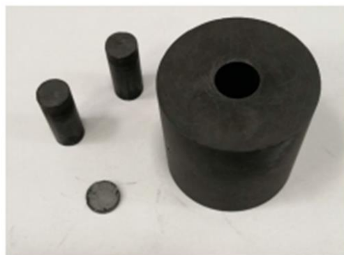
Рисунок 2.6 - Схематическое изображение графитовой матрицы, используемой в процессе ИПС
