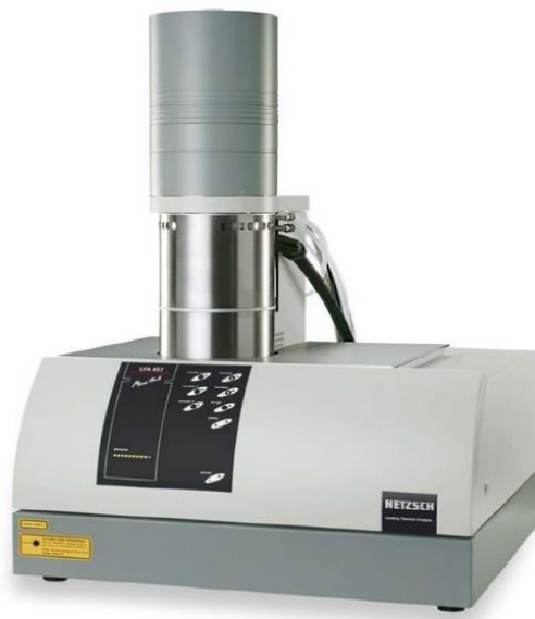
Рисунок 2.13 - Установка LFA 457 MicroFlash, Netzsch, реализующая метод лазерной вспышки для измерения температуропроводности
