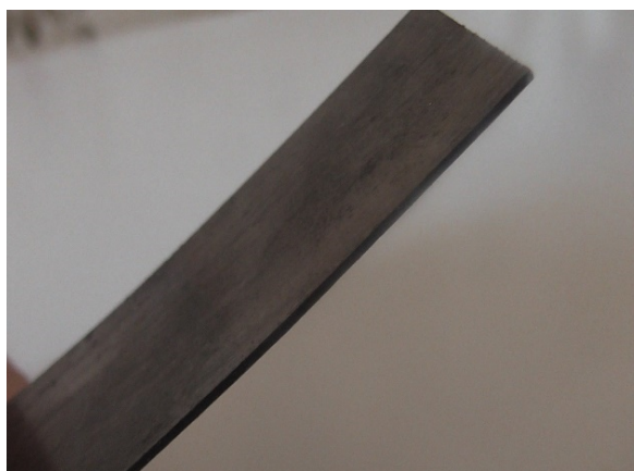
Рисунок 29. Образец стали 08Х18Н12Т подвергнутый холодной прокатке на толщину 1мм
