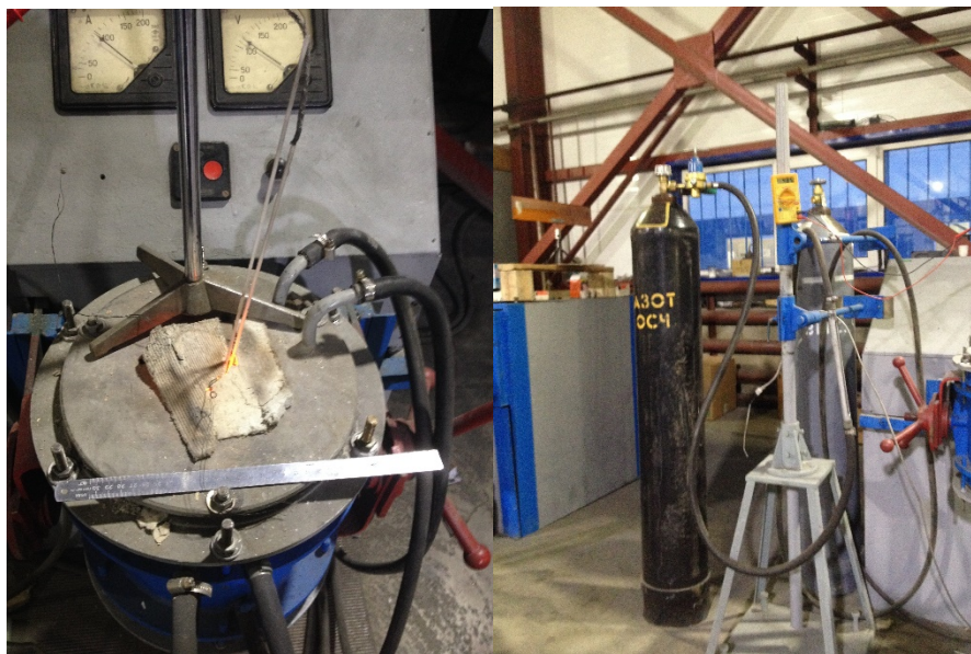
Рисунок 30. Внешний вид печи Таммана, подготовленной к процедуре твердофазного азотирования
