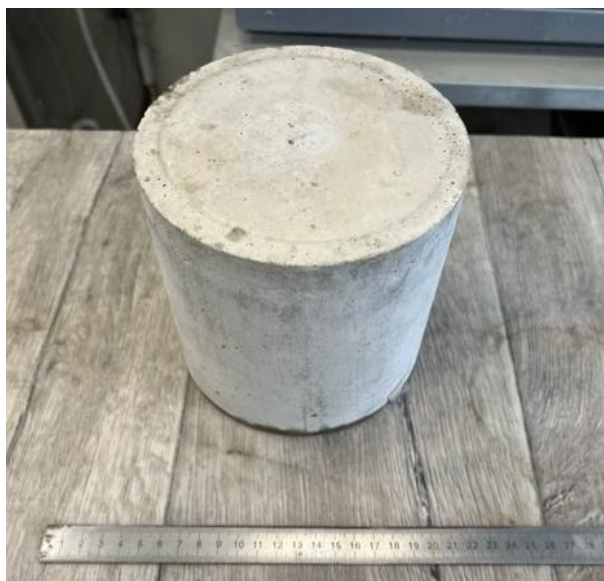
Рисунок 2.21 - Образец бетона на водонепроницаемость.
