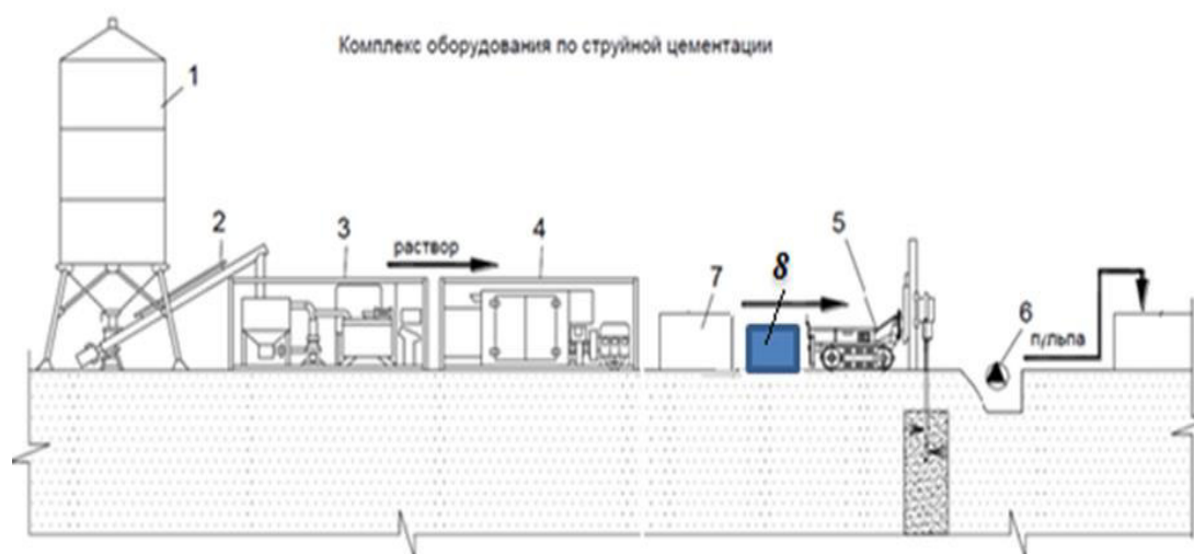
Рисунок 3.17. - Комплекс оборудования для производства колонн по технологии струйной цементации: 1 - склад силосный для хранения цемента, 2 - ленточный конвейер, 3 - смесительный растворный узел, 4 - насос высокого давления, 5 - буровая установка, 6 - грязевой насос, 7 - компрессор, 8 - дозатор для подачи добавок к вяжущему [152].
