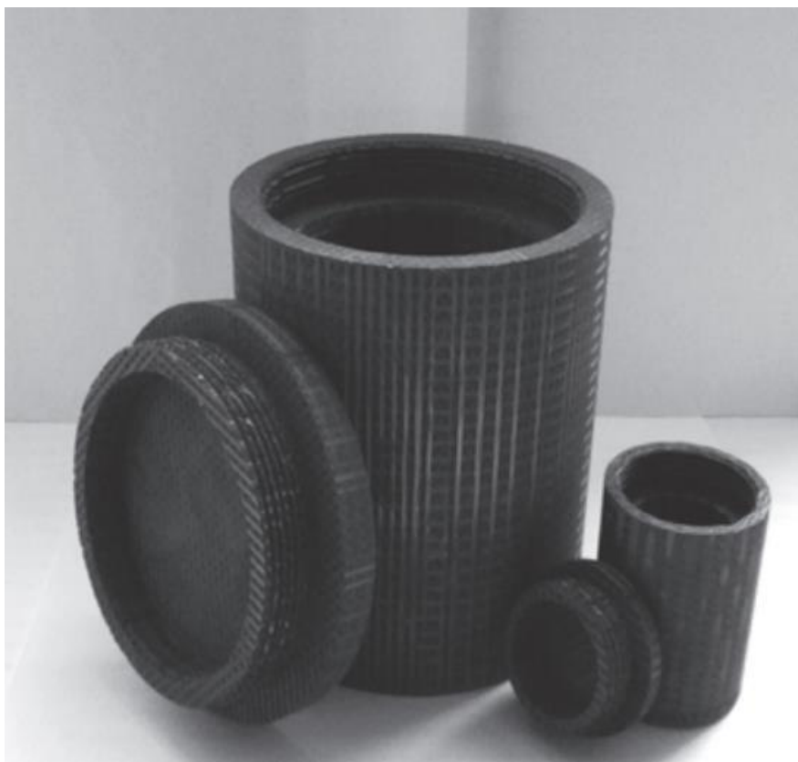
Рисунок 2.3 - Защитный контейнер из углерод-углеродного композиционного материала УУКМ [60-67].
