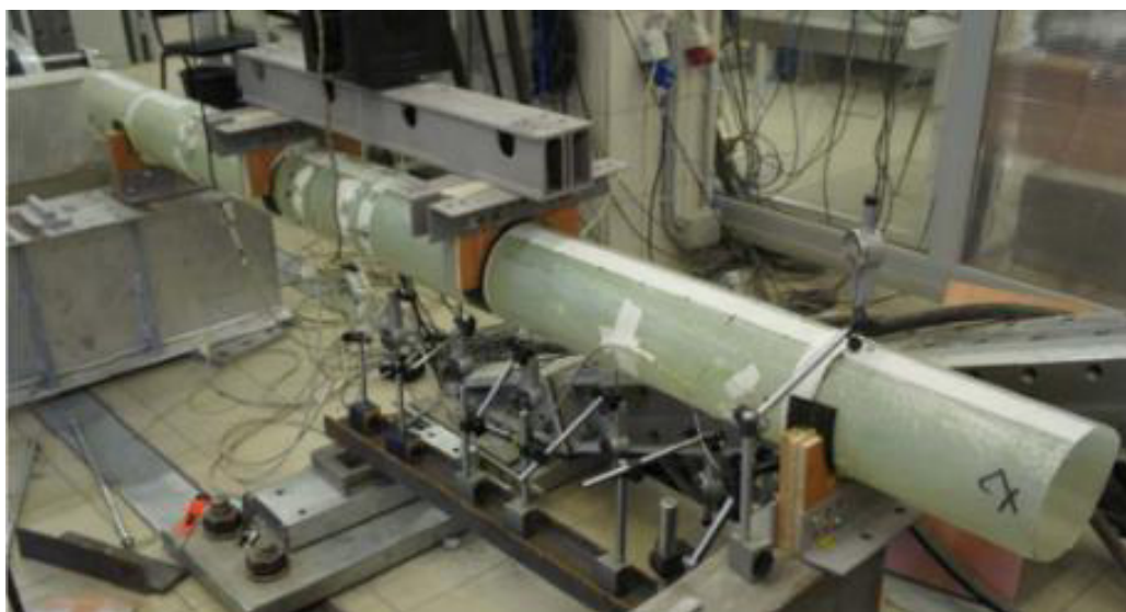
Рисунок 3.3 - Трубошпунт производства АО «НИИГрафит» на испытательном стенде предела прочности при изгибе [124].
