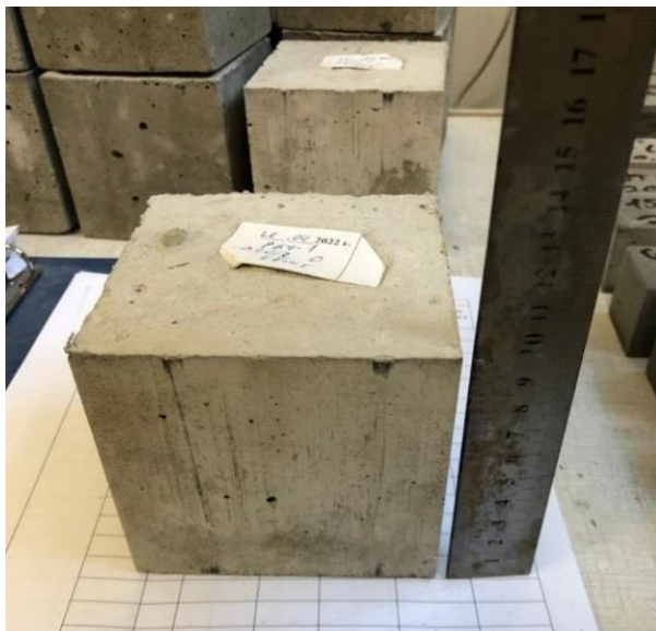
Рисунок 2.17 - Образец бетона для исследования зависимости водопоглощения от плотности.
