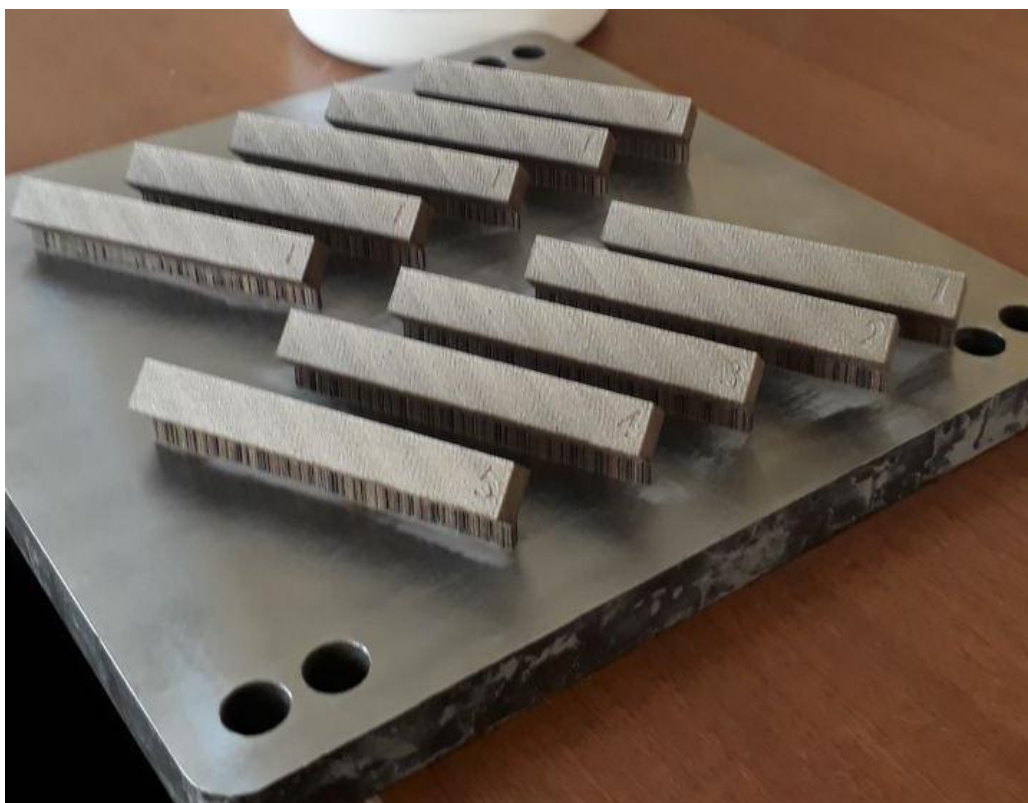
Рисунок 11 – Внешний вид экспериментальных образцов из МСС марки ПР-03Н18К9М5ТЮ с различной ориентацией на плите построения: а) 45° и 90°; б) 0°
