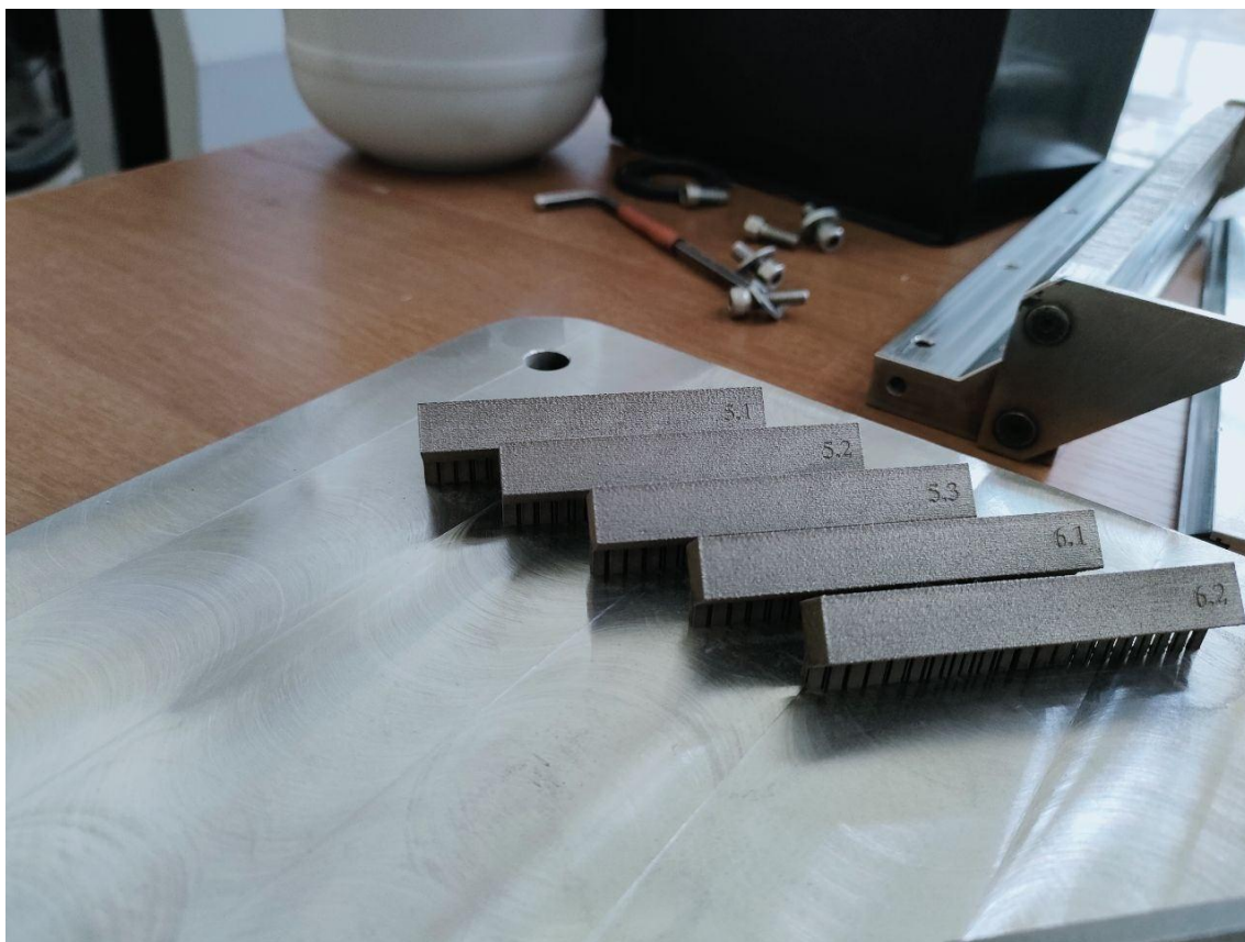
Рисунок 7 – Внешний вид СЛС-образцов, изготовленных по режимам № 5.1, 5.2, 5.3, 6.1, 6.2
