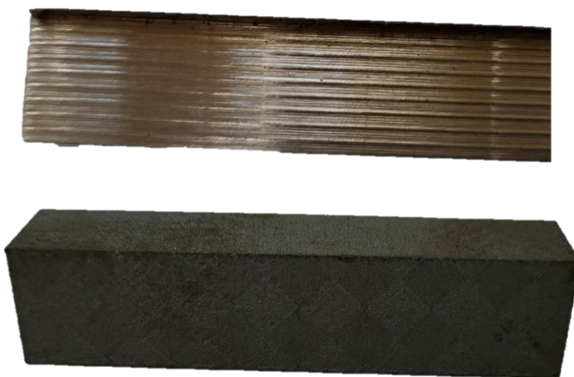
Рисунок 25 - Внешний вид поверхности образцов до проведения УКИ
