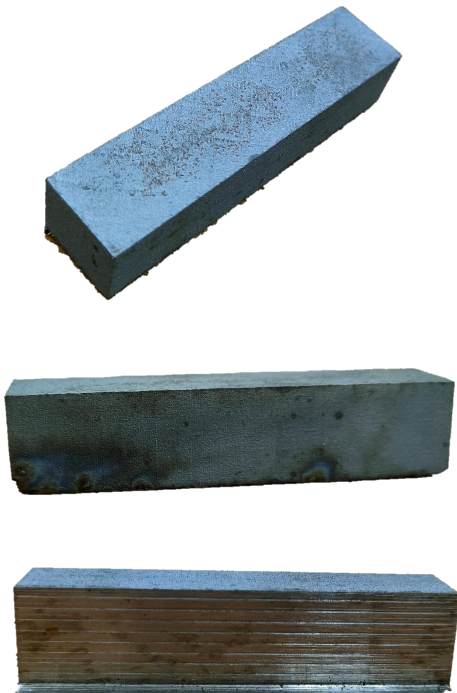
Рисунок 26 - Внешний вид поверхности образцов после проведения УКИ
