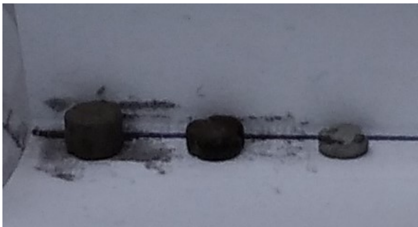
Рисунок 3.10 – Образцы Ti-Al-Nb-Mo-V 60 мин ВЭМО после проведения исследования температуры воспламенения
