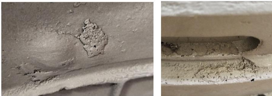
Рисунок 38 - Дефекты в виде «наплыва» на поверхности отливки
