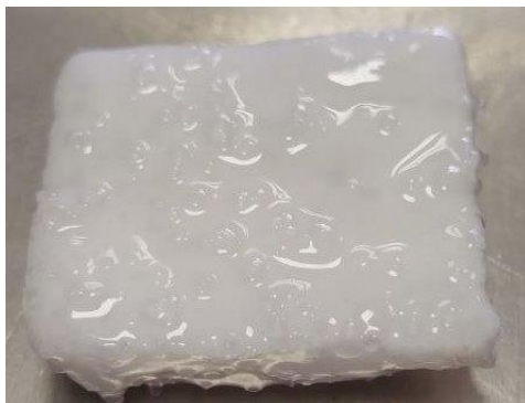
Рисунок 26 - Общий вид образца, содержащего 2 % ПВС, после частичного растворения в воде
