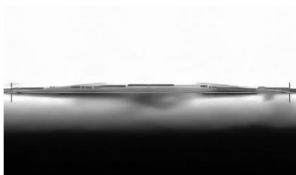
Рисунок 6 – Капля воды на гидрофильном покрытии [124]
