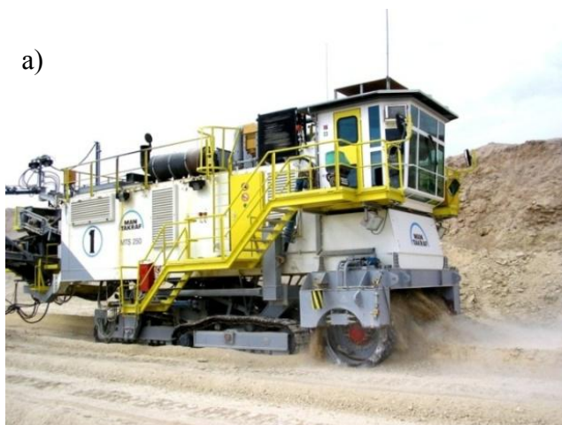
Рисунок 2.3 – а) карьерный комбайн MTS 250 на разработке продольного месторождения фосфоритов республики Узбекистан /65/ б) схема моментов действующих на шнекофрезерный рабочий орган при его вращении по часовой стрелке, где M_T - момент сопротивления трению, M_P - момент сил, необходимый для разрушения слоя фрезеруемой породы, \varphi – текущий угол поворота зуба вооружения, отсчитываемый от исходного положения точки, \varphi_0 – угол контакта витка шнека со слоем фрезеруемой породы, C_0 - толщина стружки.
