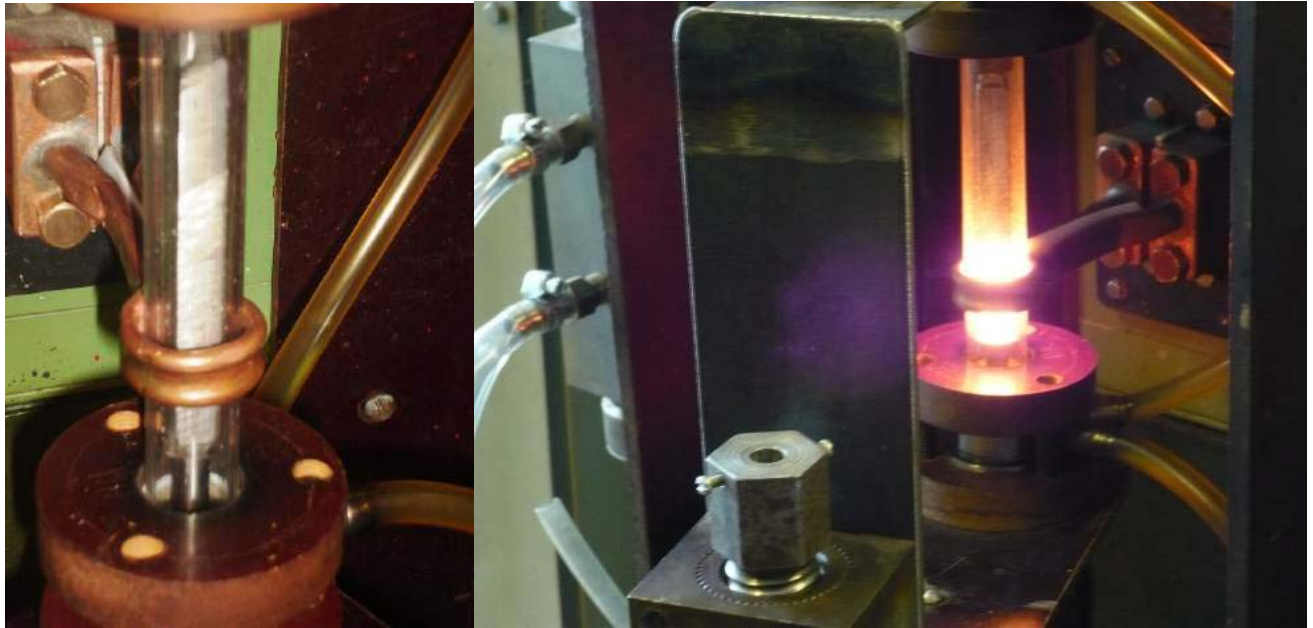
Рисунок 10.3 – (а) Реактор установки БЗП, снаряжённый исходным образцом \text{TiAl}(\text{Nb,Cr,Zr}) для переплава; (б) – установка в работе.
