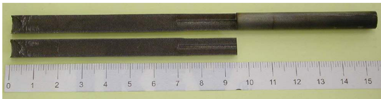
Рисунок 5.7 - Слиток Ti-Al-Nb после направленной кристаллизации: общий вид (а) и плоскости продольного осевого сечения (б), предназначенные для детального исследования.
