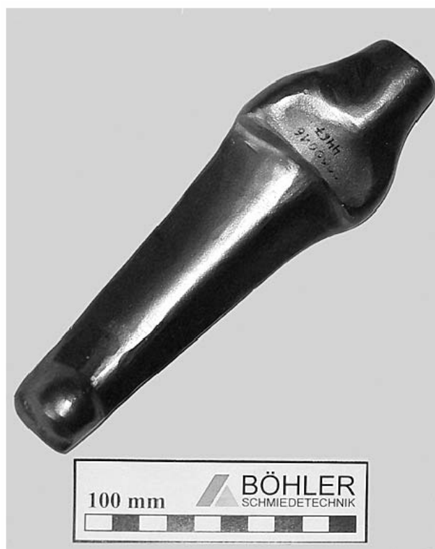
Рисунок 1.46 – Заготовка турбинной лопатки ГТД, впервые изготовленная трёхстадийным прессованием из цилиндрической отливки сплава Ti-43.5Al-4Nb-1Mo-0.1B (ат.%) с содержанием кислорода 750 масс.ppm [144].
