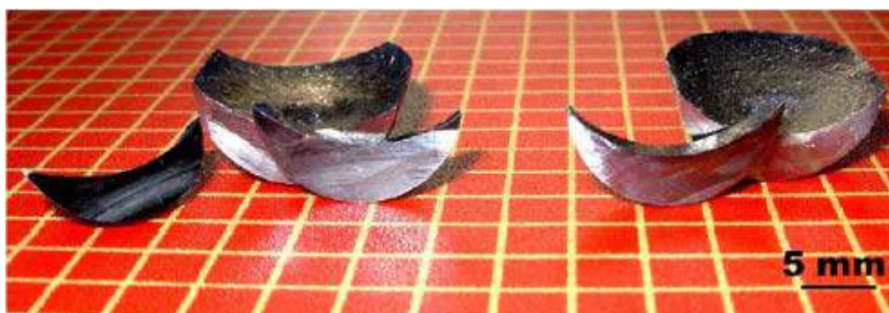
Рисунок 3.12 - Поперечные вертикальные срезы слитков \text{TiAlNb} после кристаллизации в \text{AlN} -лодочках, предназначенные для изготовления металлографических шлифов. Форма затвердевшего мениска свидетельствует о совершенной смачиваемости тиглей расплавом.
