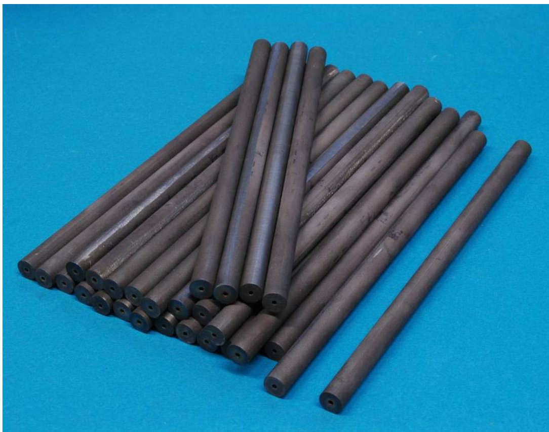
Рисунок 5.6 - Исходные стержни номинального состава Ti-46Al-8Nb (ат.%), предназначенные для экспериментов по направленной перекристаллизации и микроструктурной инженерии сплава.
