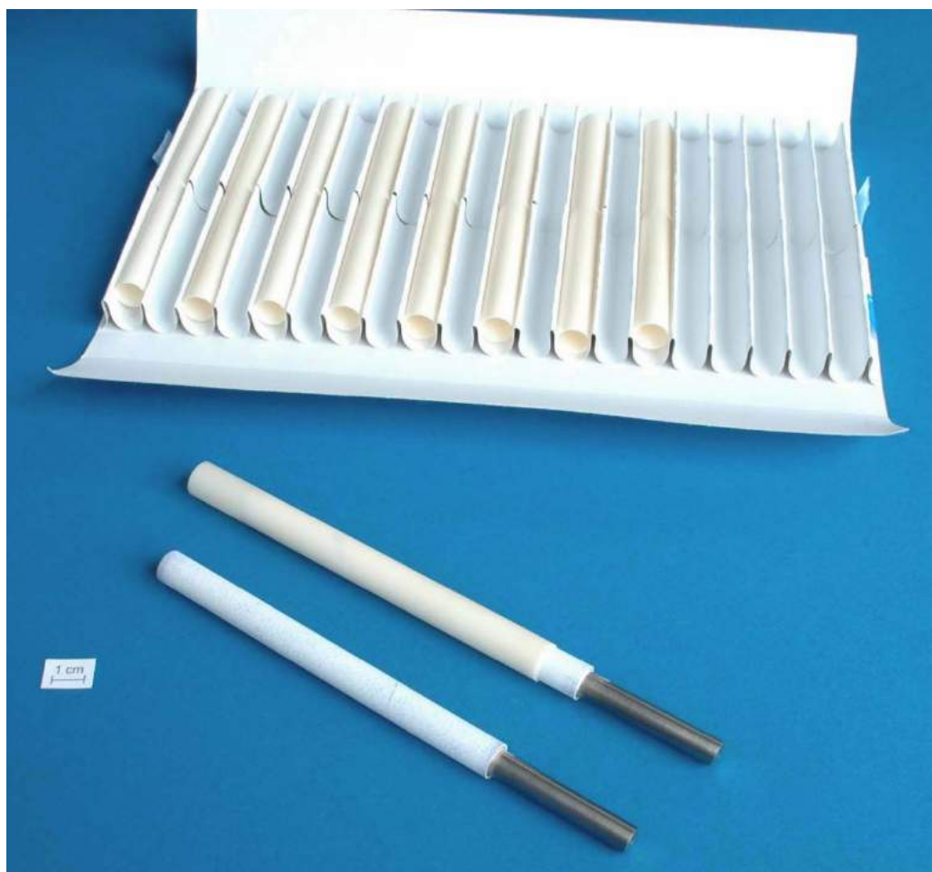
Рисунок 5.5 - Тигли из термостойкой спецкерамики Y_2O_3 фирмы Reetz, используемые в процессах направленной перекристаллизации интерметаллического сплава Ti-46Al-8Nb. На переднем плане – исходные стержни TiAl(Nb), помещённые в тигли перед зарядкой в тепловой узел кристаллизационной установки.
