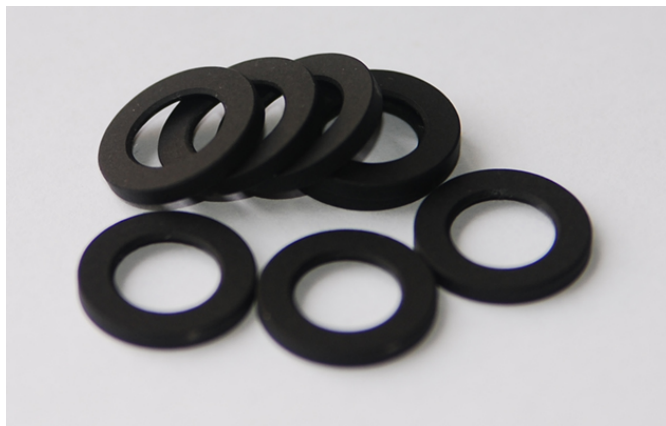
Рисунок 6 – Фотографии окуляров из сплава BT1-0 с черным декоративным износостойким покрытием
