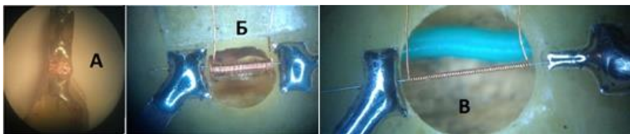
Рисунок 1 – фотографии МИ чувствительных элементов (А- на подложке, Б- на микрокаркасе, В- бескаркасный).
